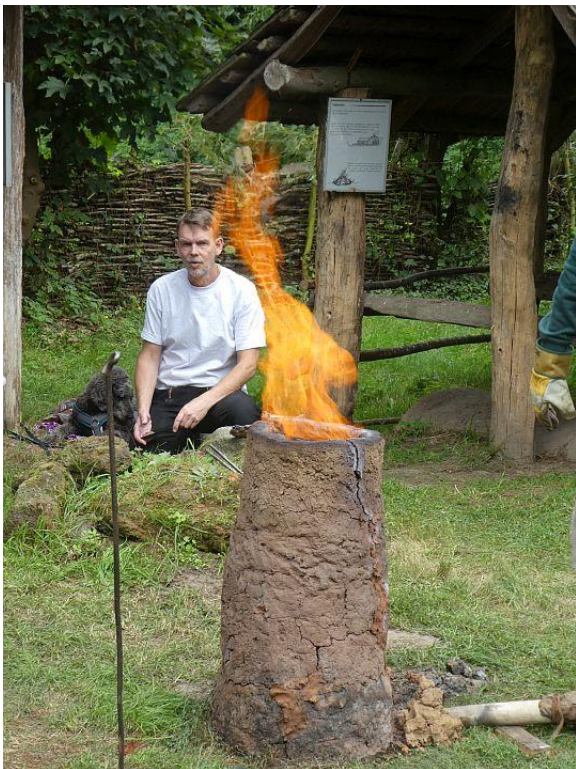
Kleiner Schachtofen, 1 Düse,
